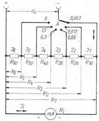
Bild 14. Gleichstrommesser mit 6 Meßbereichen. Kontaktwiderstände im Bereichschalter können die Nebenwiderstände nicht fälschen. Gesamtnebenwiderstand  $R_1$  liegt dem Meßwerk ständig parallel. Dadurch Meßwerkempfindlichkeit nur mit 20 bis 30% ausnutzbar. Spannungsverbrauch  $U_v$  steigt mit wachsendem Meßbereich
