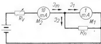
Bild 17. Ermittlung von Nebenwiderständen für  $M_1$  mittels Stromvergleich durch  $M_2$
