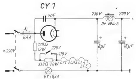
Bild 6. Allstrom-Netzteil
