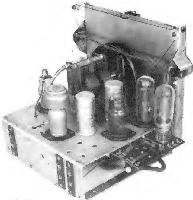
Bild 1. Chassisansicht des Bandfilter-Zweikreislers
