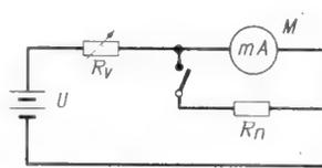
Bild 18. Einmalige Meßbereichserweiterung 1:2 bis 1:5 durch Ausschlagvergleich. Eichnormalen und Kenntnis des Meßwerksinnenwiderstandes sind nicht erforderlich
