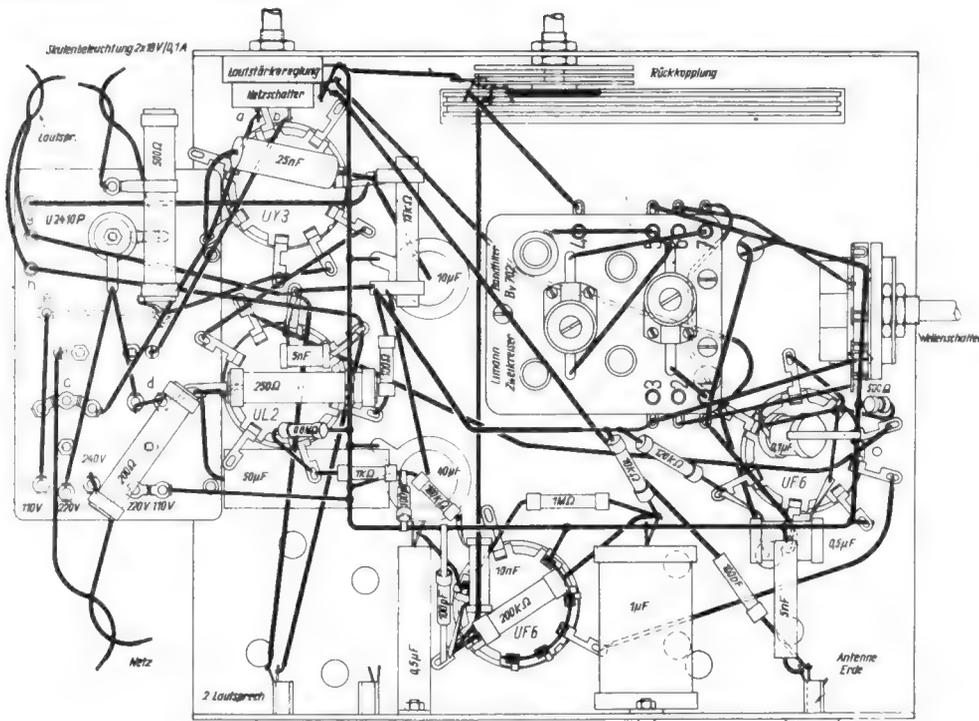
Bild 4. Verdrahtungsskizze
