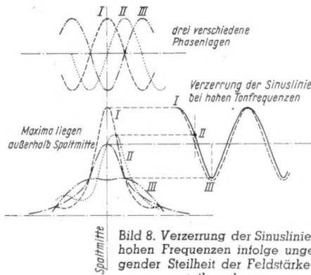
Bild 8. Verzerrung der Sinuslinie bei hohen Frequenzen infolge ungenügender Steilheit der Feldstärkeverteilungskurve
