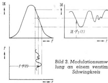
Bild 3. Modulationsumwandlung an einem verstimmtten Schwingkreis
