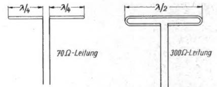
Bild 8. Antennenformen (Links: Dipolantenne, rechts: Gefalteter Dipol)
