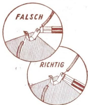
Der **ENGEL-LÖTER** dagegen arbeitet nach dem Prinzip der Erwärmung eines Leiters bei spezifisch hohem Stromdurchfluß.
