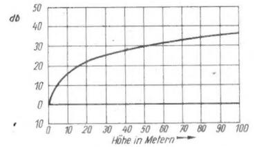
Bild 2. Korrekturfaktor zur Berücksichtigung der Höhe auf beiden Seiten als Funktion der Höhe
