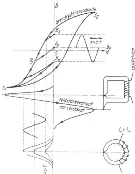
Bild 7. Aufsperrvorgang bei Arbeitspunkt auf der Grenzhystereseschleife
