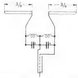
Bild 8. UKW-Empfangsantenne (Dipol-Anordnung)
