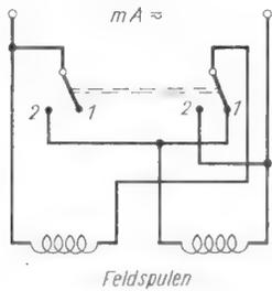
Bild 20. Dreheisen-Strommesser mit zwei gleichen umschaltbaren Feldspulen zur Meßbereichänderung. Kleiner Bereich: Spulen in Reihe; größerer Bereich: Spulen parallel
