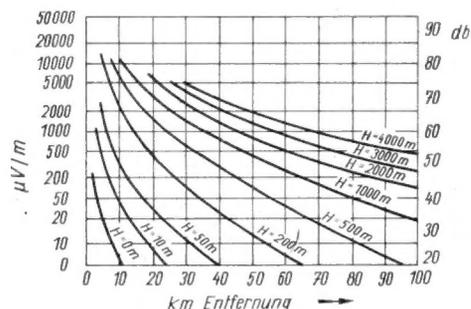
Bild 1. Feldstärke als Funktion der Entfernung für eine geübte 4-m-Welle über Erde (H = Höhe der Sender- oder Empfangsantenne)
