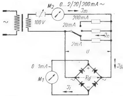
Bild 21. Wechselstrommesser mit Drehspulmeßwerk und Trockengleichrichter in Grätzschaltung. Im 1. und 2. Bereich ist der Verlauf des Stromverhältnisses  $I_n : I_{G1}$  nicht gleich. Dadurch stimmen Skalenverläufe im 1. und 2. Bereich nicht überein
