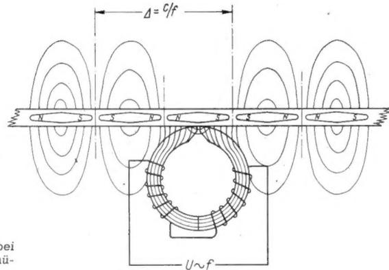
Bild 9. Kraftlinienverlauf des Bandes am Hörkopf
