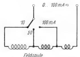
Bild 19. Dreheisen-Strommesser mit Abgriffen an der Feldspule zur Meßbereichsänderung
