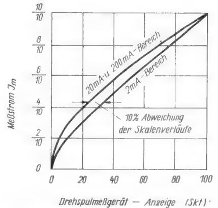
Bild 22. Eichkurven der Schaltung Bild 21. Abweichung der Kurven ist bedingt durch Änderung des dem Gleichrichter parallel liegenden Nebenwiderstandes
