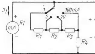
Bild 13. Gleichstrommesser mit in Reihe liegenden Nebenwiderständen zur Einsparung von Widerstandsdräht
