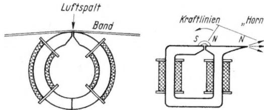
Bild 3. Magnetofon-Ringkopf
