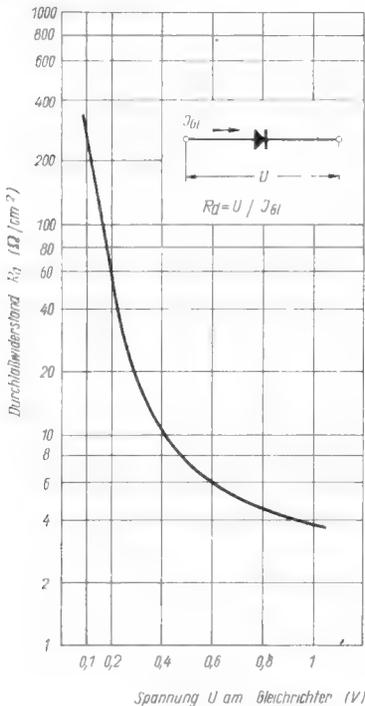
Bild 23. Abhängigkeit des Durchlaßwiderstandes eines Kupferoxydulgleichrichters von der an ihm liegenden Spannung
