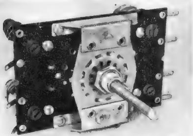
Bild 6. Spulenaggregat (Rückseite)
