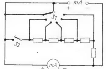
Bild 15. Schaltung wie Bild 14, jedoch Nebenwiderstände abschaltbar zur Ausnutzung der vollen Meßwerkempfindlichkeit im kleinsten Meßbereich
