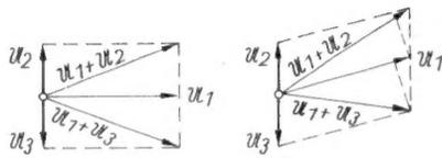
Bild 6. Vektor-Diagramme zur Modulationsumwandlung (Links: Frequenzabweichung Null; rechts: Endliche Frequenzabweichung)
